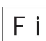
Le symbole clignotera à une fréquence de deux fois par seconde pendant trois minutes, connectant le smartphone à l'appareil de chauffage pendant cette période.
